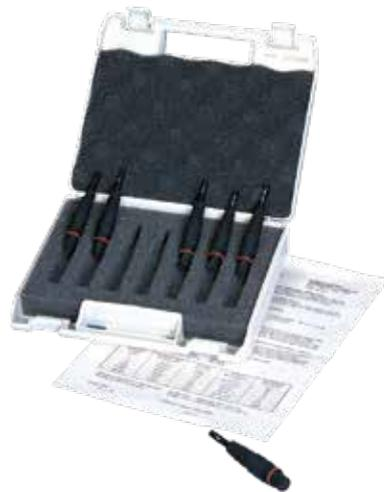
Abb. 10 Set mit rückführbar zertifizierten Präzisionswiderständen
