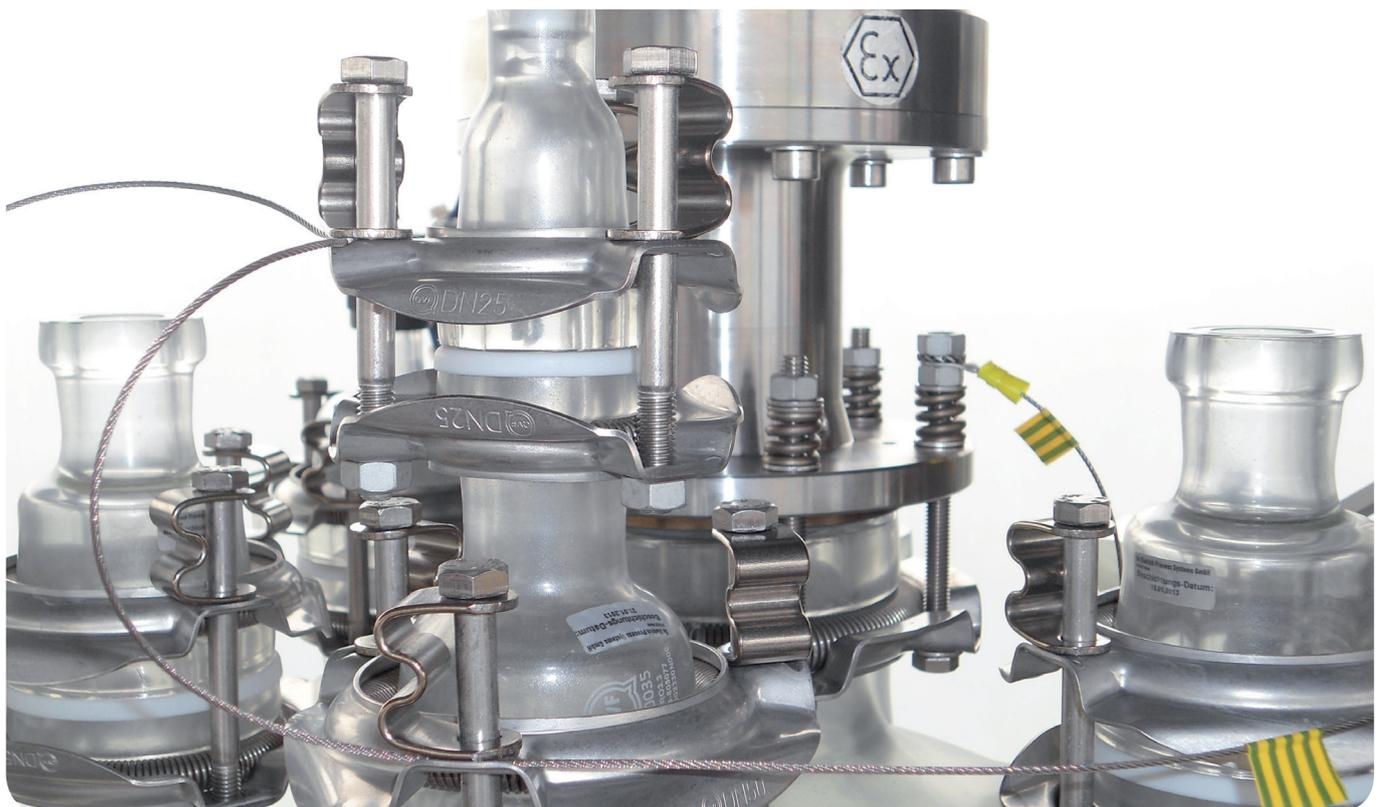
Abb.1: Potentialausgleich der Metallflansche durch fest verklebten Edelstahldraht
