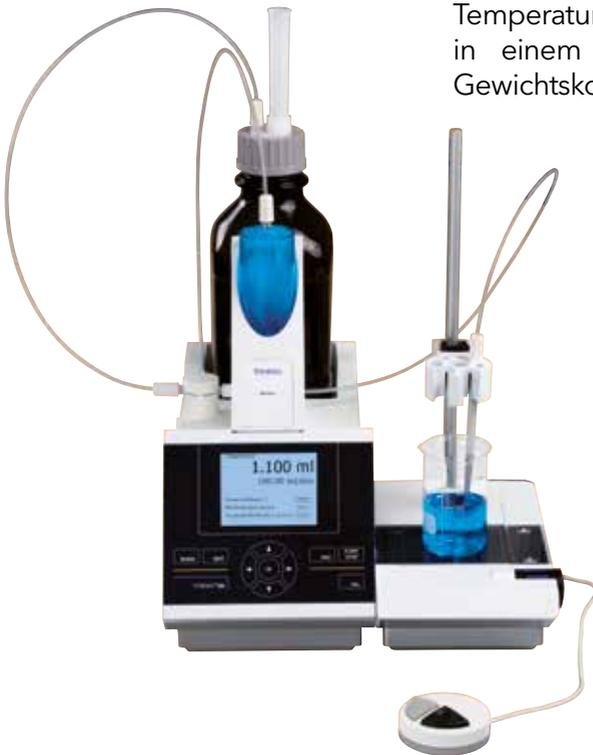
Fig. 18 Probenvorbereitung mit der Kolbenbürette TITRONIC® 500
