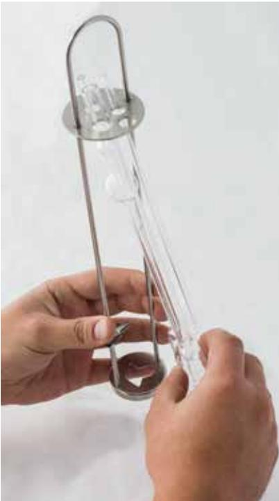
Abb. 14 Einsetzen des Viskosimeters in ein Fixiergestell
